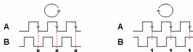
Obr. 3: Princip rotačního enkodéru (převzato z [14])
