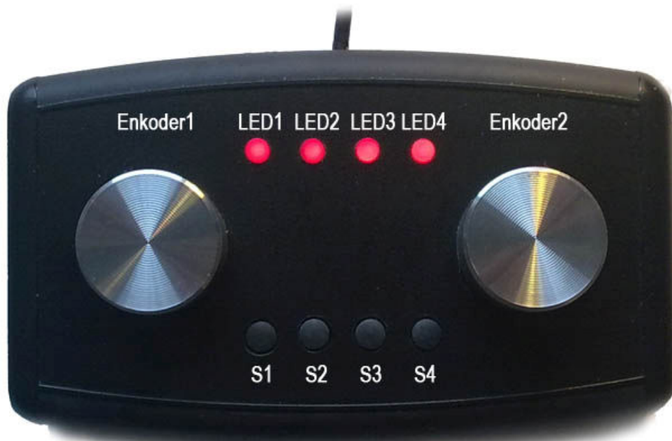
Obr. 5: Pohled na hotový ovladač, rozmístění ovládacích prvků
